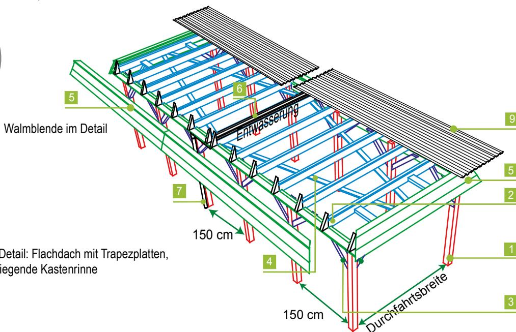
Explosions-Detail: Flachdach mit Trapezplatten,
