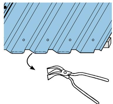
Die Trapezprofilenden müssen ca. 10 mm umbogen werden damit das Wasser ungehindert von den Trapezprofilen ablaufen kann.
